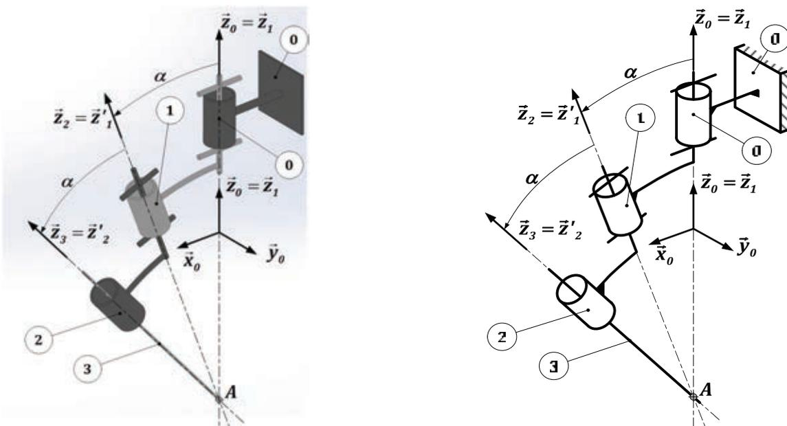
**Figure 7 :** Modèle cinématique de la solution architecturale proposée par l'équipe RobioSS de l'institut de recherche Pprime. Les schémas sont proposés pour une configuration particulière :  $\theta_1 = 0$  ;  $\theta_2 = 0$  et  $\theta_3 = 0$  (voir figures de définition des angles en annexes A5 et A6)
