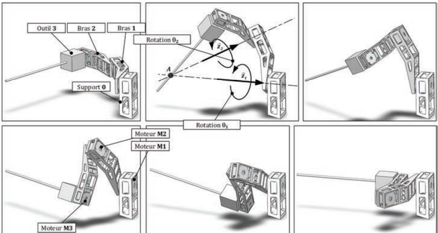
**Figure 17 : Description du mouvement critique du robot**
