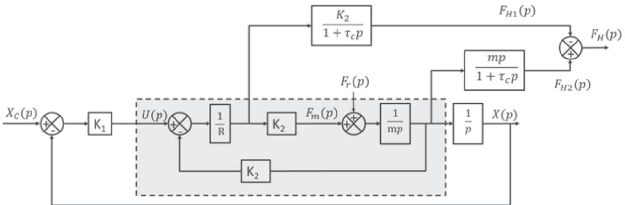
Figure 21 : Principe de l'estimation de l'effort perturbateur
