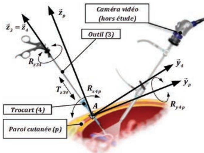
Figure 6 : Implantation de l'outil chirurgical et du trocart dans la paroi cutanée du patient ; représentation des mobilités. (Le plan  $(A, \vec{y}_3, \vec{z}_3)$  n'est pas dans le plan de projection du schéma)
