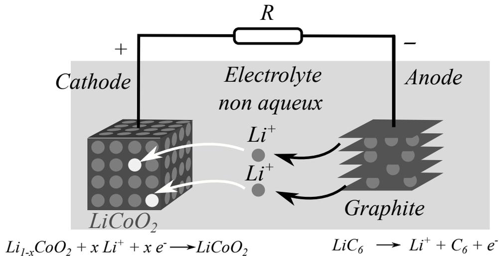
**Figure 9** – Schéma de fonctionnement de l'accumulateur lithium-ion
