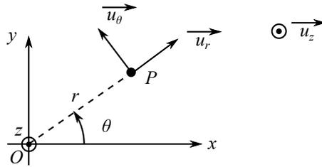
**Figure 4** – Paramétrage cylindrique
