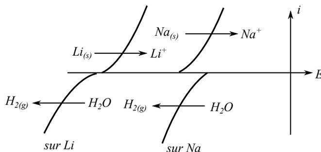
**Figure 10** – Courbes intensité-potentiel à pH = 7,0
