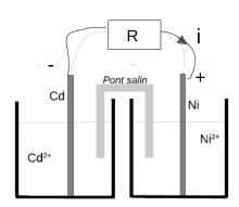
L'intensité va de l'électrode de Cd (2) vers l'électrode de Ni (1).
