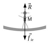
A l'équilibre dans la station, la réaction de la paroi compense la force d'inertie d'entrainement, force axifuge jouant le rôle de "poids".
