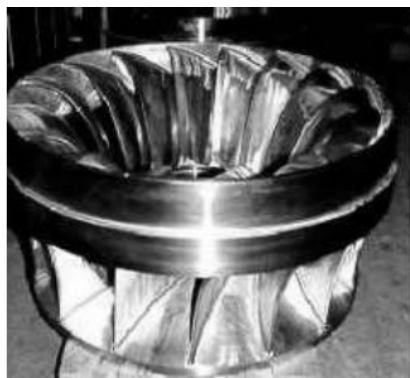
Roue d'une turbine Francis et profil tridimensionnel des aubes
